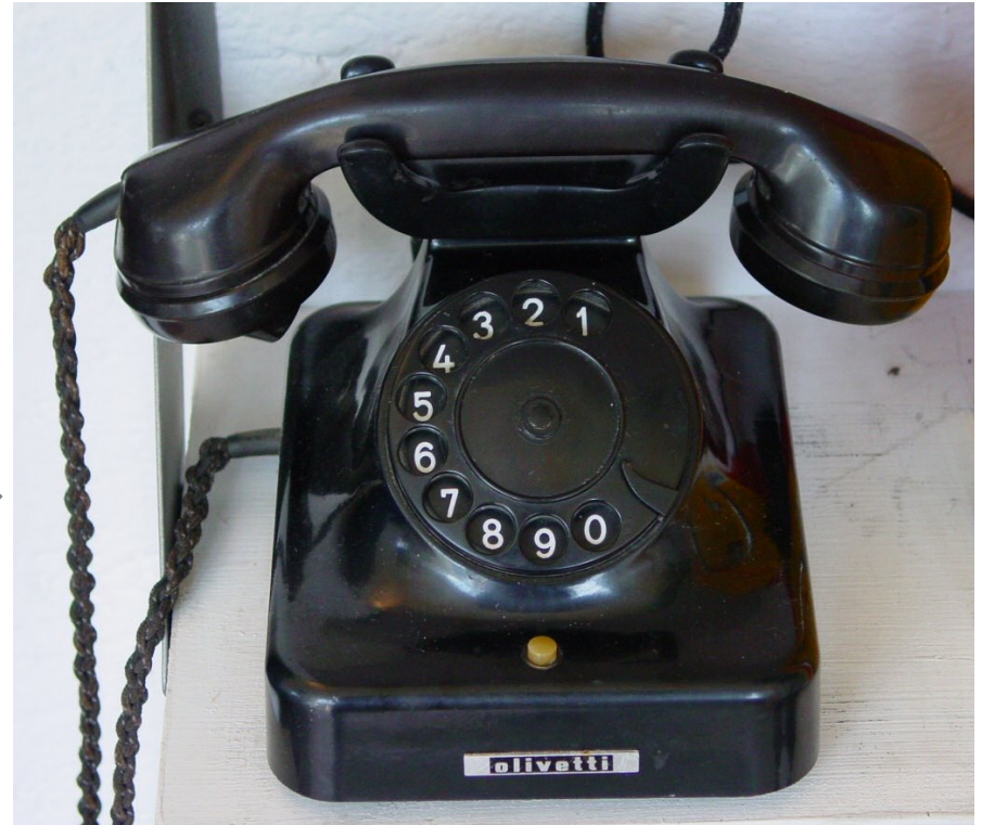
回転ダイヤル式(ダイヤルパルス式) 黒電話(1940年代、オリベッティ社製)
